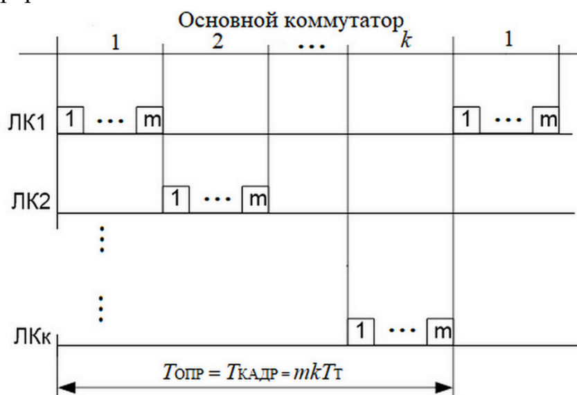
Рис. 4.11 – Временные диаграммы при меньшей частоте переключения цепей основного коммутатора
